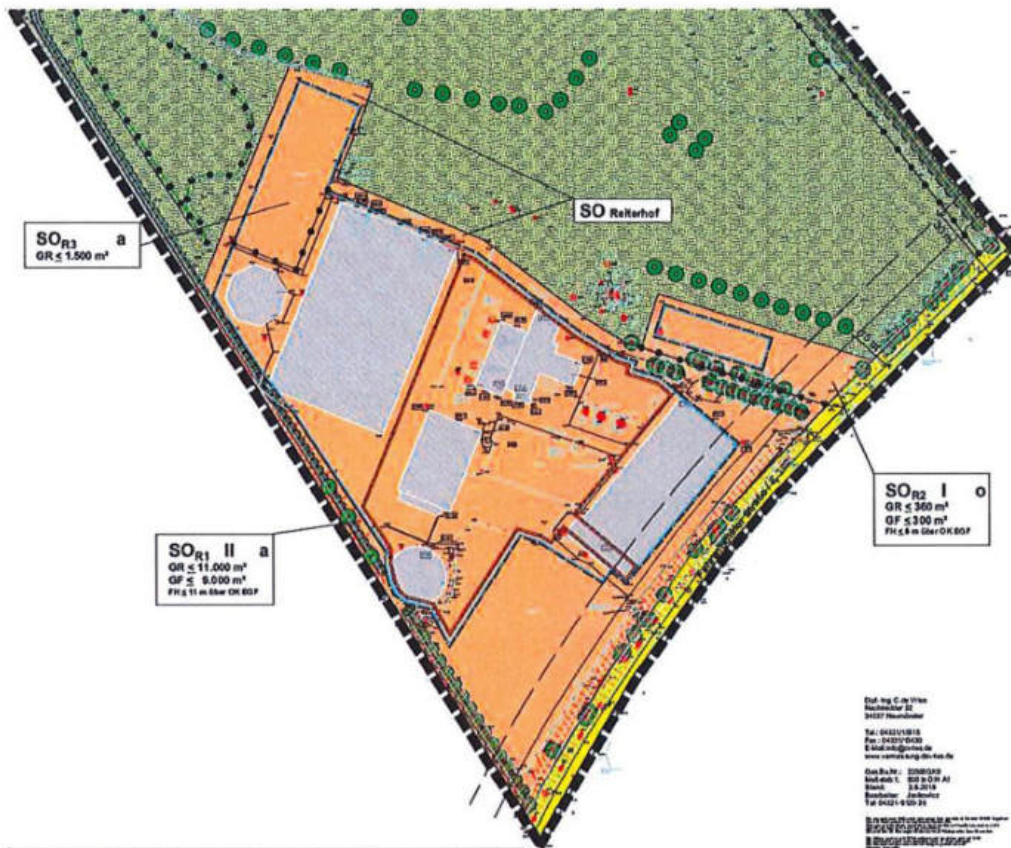
Abbildung 4 Ausschnitt aus dem Entwurf zum Bebauungsplan Nr. 7 Radesforder Hof: Bestand Gebäude (hellgelb) und Planung Gebäude (braun) mit Flächenangaben
