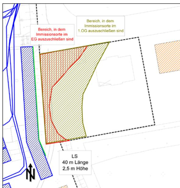
Von den vorgenannten Festsetzungen kann abgewichen werden, wenn im Rahmen eines Einzelnachweises ermittelt wird, dass aus der tatsächlichen Lärmbelastung an den Gebäudefassaden die Anforderungen der TA Lärm durch den Gewerbelärm eingehalten werden.
