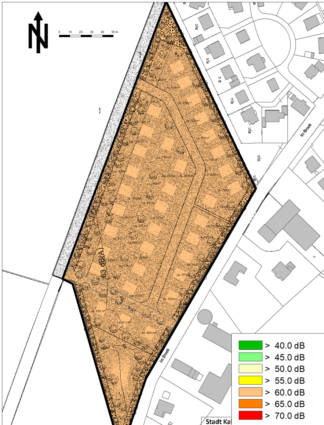
Abbildung 1: maßgeblicher Außenlärmpegel für schutzbedürftige Räume
