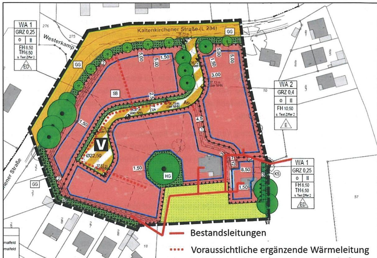
Abbildung 13: Fernwärmenetz: Bestandsleitungen & voraussichtlich geplante Wärmeleitungen (Stand Juni 2022), Quelle: Energiehof Schmalfeld.
