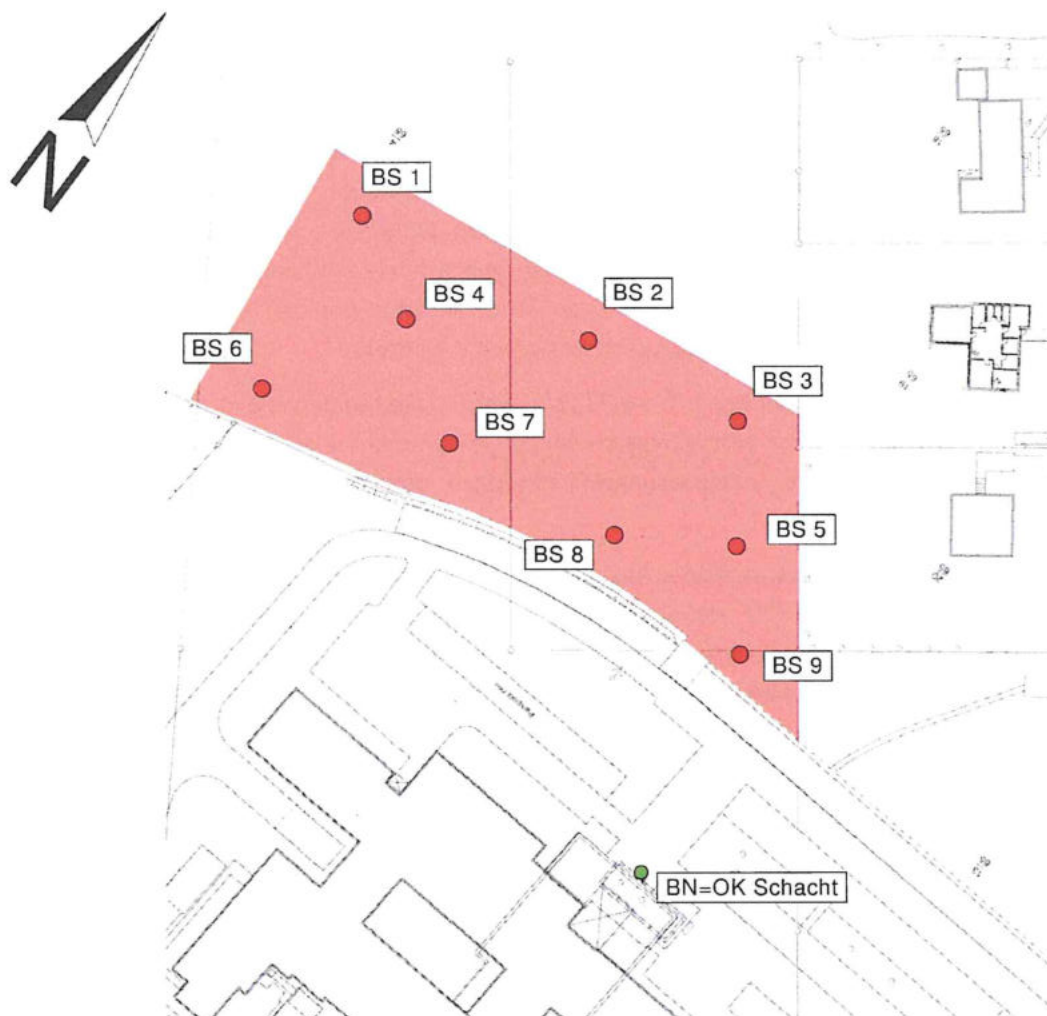
Abbildung 11: Lageskizze der Bohrpunkte, Auszug aus der Baugrunduntersuchung
