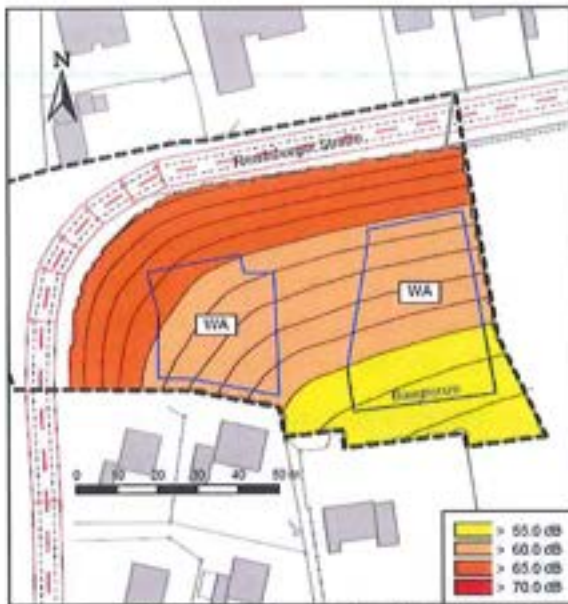
Abb. 6: maßgeblicher Außenlärmpegel für schutzbedürftige Räume (Abb. 1 der schalltechnischen Untersuchung)
