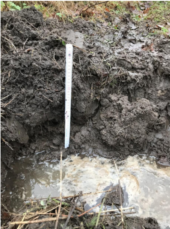
Bild 9: Schurf mit Stauwasser an BS6
