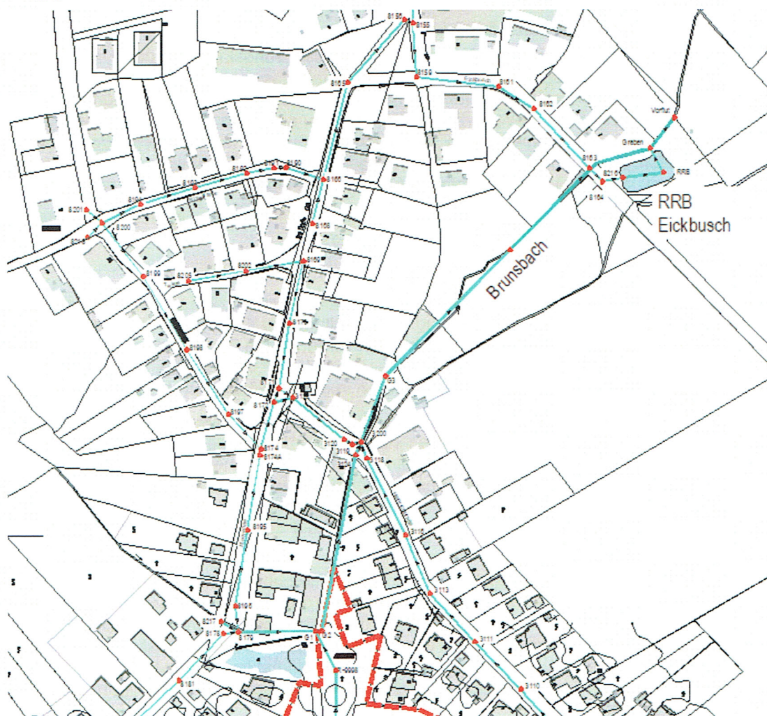
Abb. 3: Vorgesehene Abführung des Niederschlagswassers
