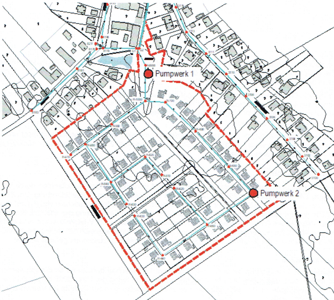
Abb. 4: Vorgesehene Abführung des Schmutzwassers
