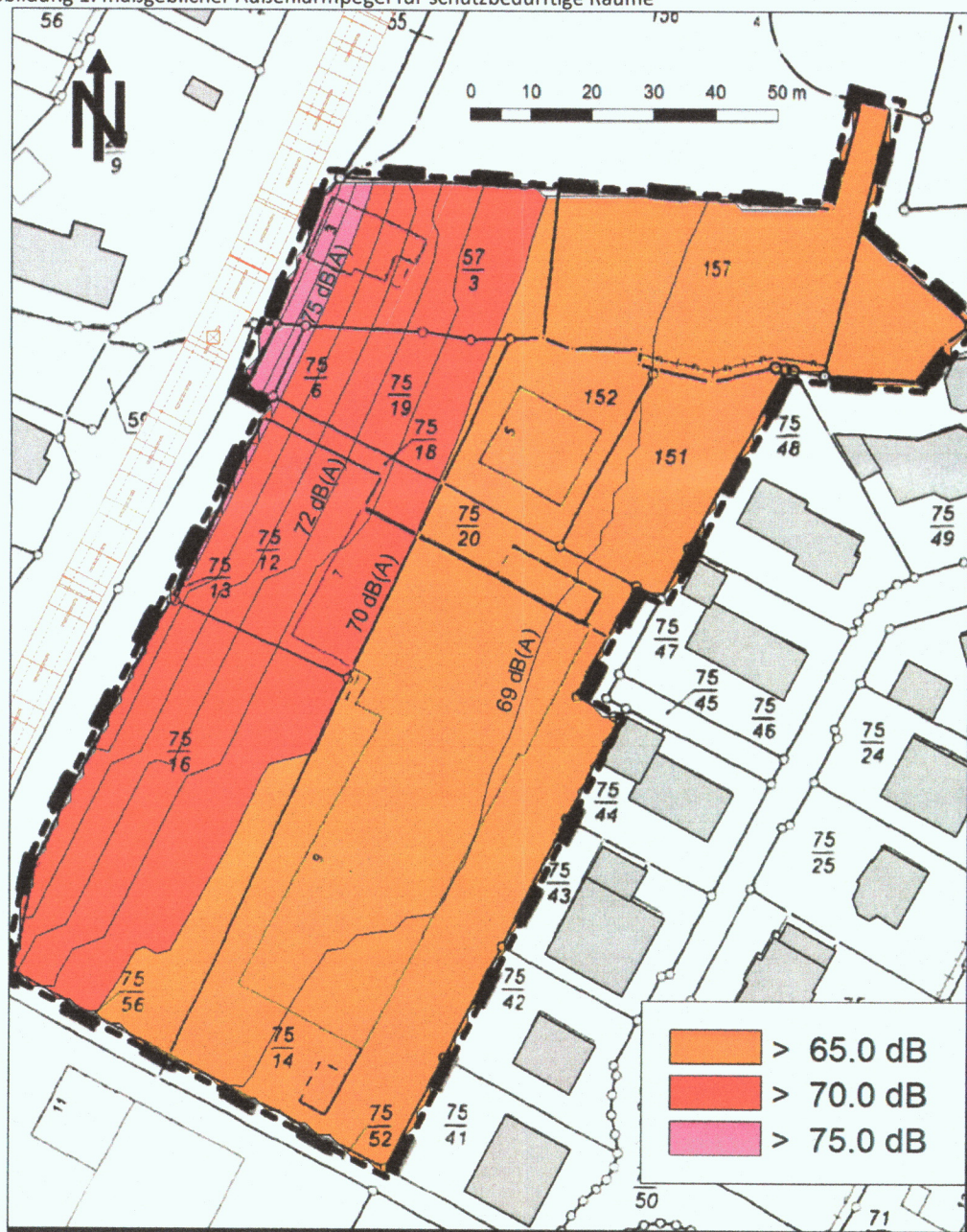
Abbildung 1: maßgeblicher Außenlärmpegel für schutzbedürftige Räume
