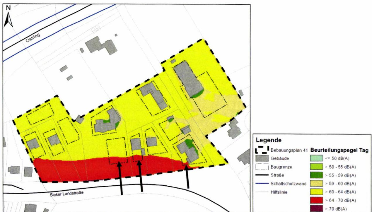
**Abbildung 3:** Auszug aus Anlage 2b der schalltechnischen Untersuchung der Lärmkontor GmbH vom 01.04.2014 - Schallimmissionsplan Straßenverkehr mit Beurteilungspegel (tags)
