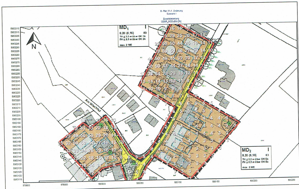
Abb. 8: Geruchshäufigkeiten im Umfeld des B-Planes 11-1.Änderung, Szenario I dargestellt als Zahlenwerte in % der Jahresstunden Wahrnehmungshäufigkeit interpoliert aus einem geschachtelten Gitter, dargestellt in einem 10 m Raster. M 1: ~2.500, AKterm Hamburg-Fuhlsbüttel
