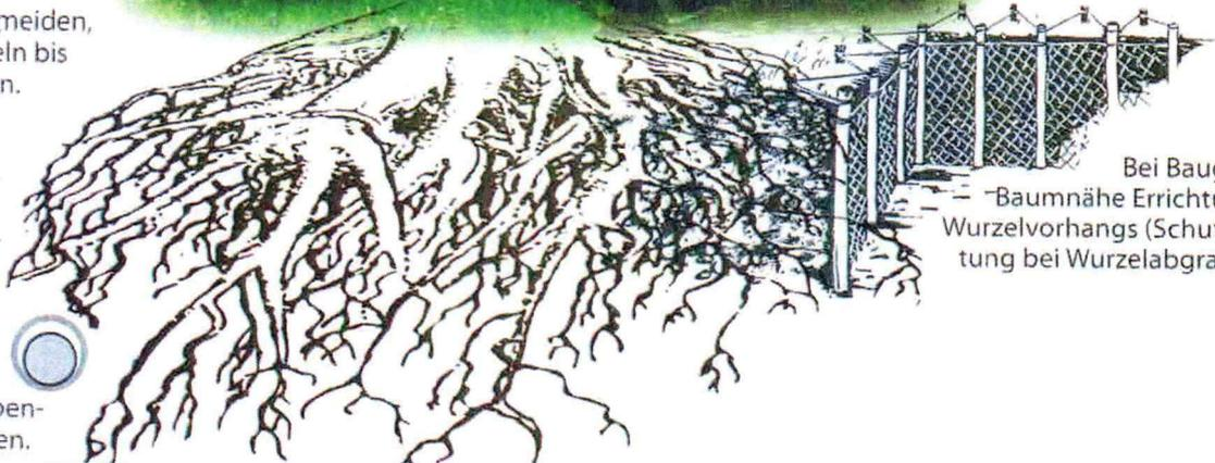
Bei Baugruben in Baumnähe Errichtung eines Wurzelvorhangs (Schutzvorrichtung bei Wurzelabgrabungen).
