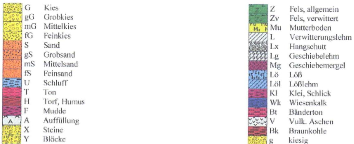
Abbildung 15: Zeichenerklärung der Schichten (Quelle: Baugrunduntersuchung der ERWATEC Arndt mbH,18.01.2022)
