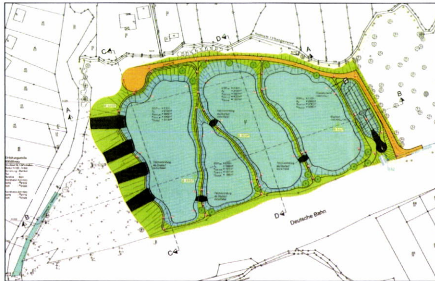
Auszug aus der Genehmigungsplanung für die Regenrückhalteanlage
