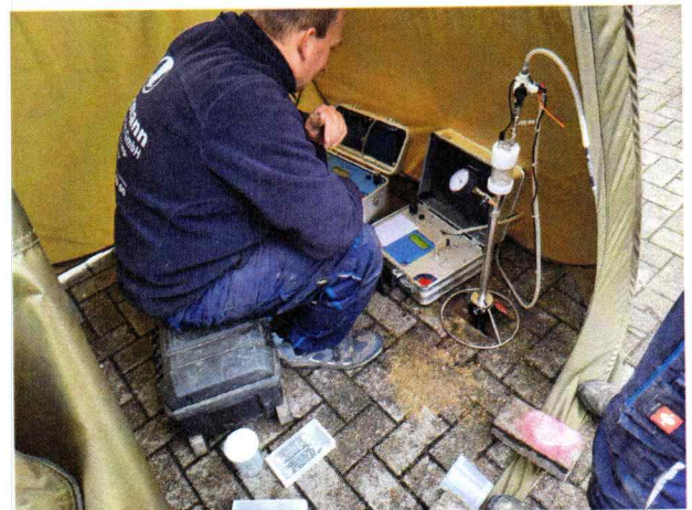
Foto 4: Bodenluftprobenahme an KRB 2 (Beispiel)
