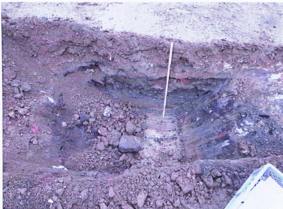
Foto 2: Baggerschurf S1 (ehemalige Lagerfläche von Halde II).
